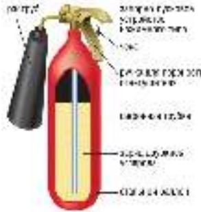
Устройство с зарядом двуоксида углерода (CO<sub>2</sub>) сжиженной, это позволяет снижать температуру и вытеснять кислород в месте возгорания.
